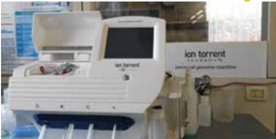
Lo strumento di Next generation sequencing in dotazione a Coop Italia. Il suo nome, Ion Torrent, indica la tecnologia di sequenziamento del DNA di ultima generazione.
